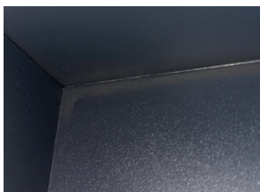
Niewystarczająca grubość powłoki na krawędziach wewnętrznych
