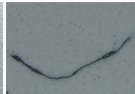
Włókna na utwardzonej powłoce
