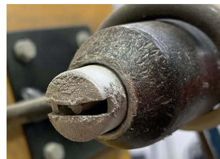
Osady spowodowane spiekaniem na dyszy proszkowej
