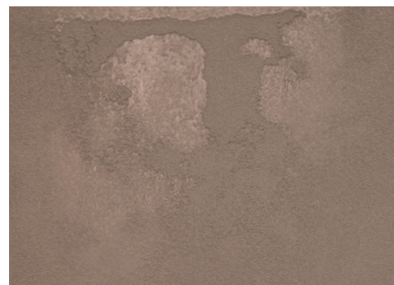
Proszek odpada po napyleniu
