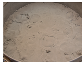
Pęcherze / proszek kipi z podajnika
