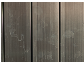
Plamy na powlekanym elemencie obrabianym
