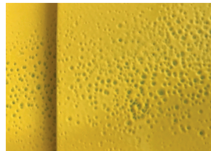
Niedostateczne zwilżenie spowodowane niedostateczną przyczepnością proszku
