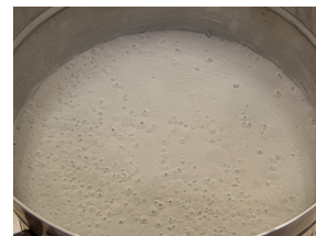
Otwory / kanały powietrzne we fluidyzowanej powierzchni
