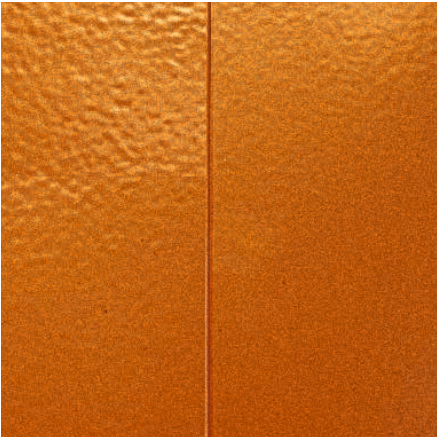
Zu hohe Schichtstärke kann zu Orangenhaut führen
