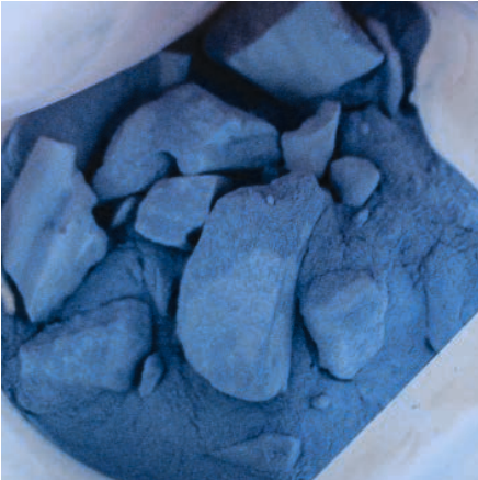
Klumpenbildung in Pulverkarton oder Fluidbehälter
