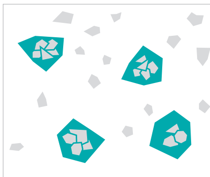
Technologia bondingu częściowe wiązanie cząstek efektu z ziarnem farby proszkowej
